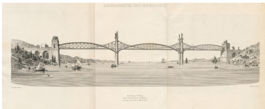
1 Rupperts Entwurf für eine Eisenbahnbrücke über den Bosphorus, 1864 [Carl von Ruppert, Neues System für Eisenbrücken grosser Spannweiten, Wien 1867]
