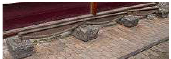
13 Gusseiserne Schiene von William Jessop, 91 cm lang, 1789
