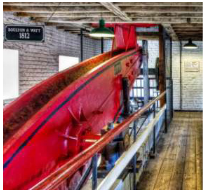
6 Boulton und Watts Dampfmaschine für Pumpen mit gusseisernem Balken, 1812
