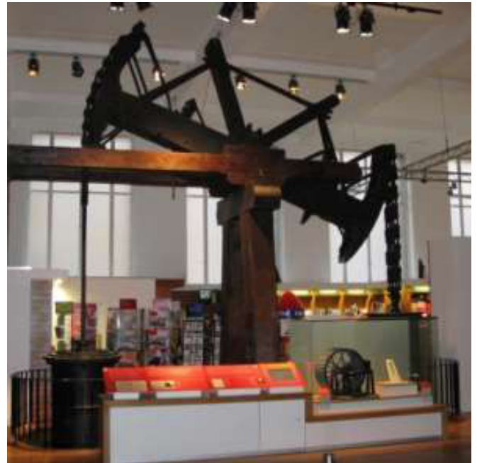
5 Boulton und Watts Dampfmaschine mit einem mit Eisenstangen verstärkten Holzbalken, 1777
