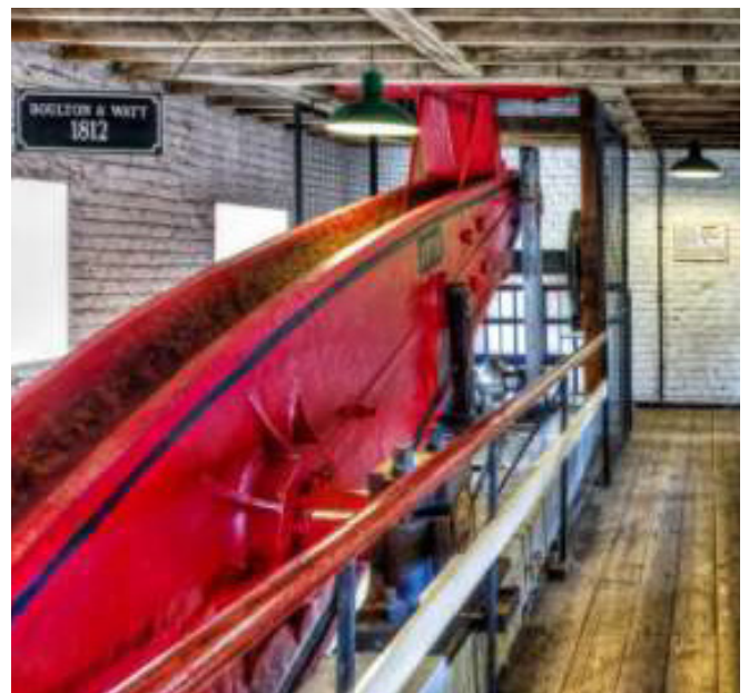
6 Boulton und Watts Dampfmaschine für Pumpen mit gusseisernem Balken, 1812
