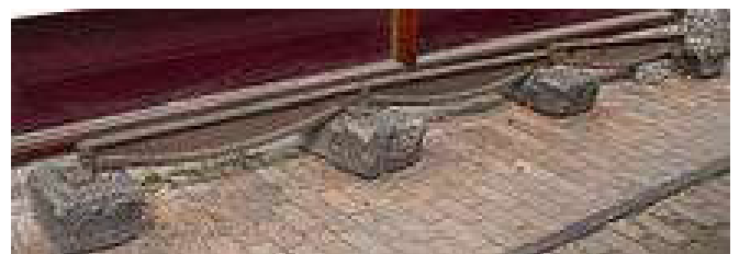
13 Gusseiserne Schiene von William Jessop, 91 cm lang, 1789
