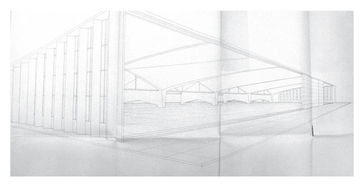
Fig. 1: Unrealised project (1932) by Laffaille for a « Caquot » type aircraft hangar with thin concrete shells (Fonds Laffaille, file 206 ifa 59/2 –SIAF/cité de l'architecture et du patrimoine/Archives d'architecture du XXe siècle).
