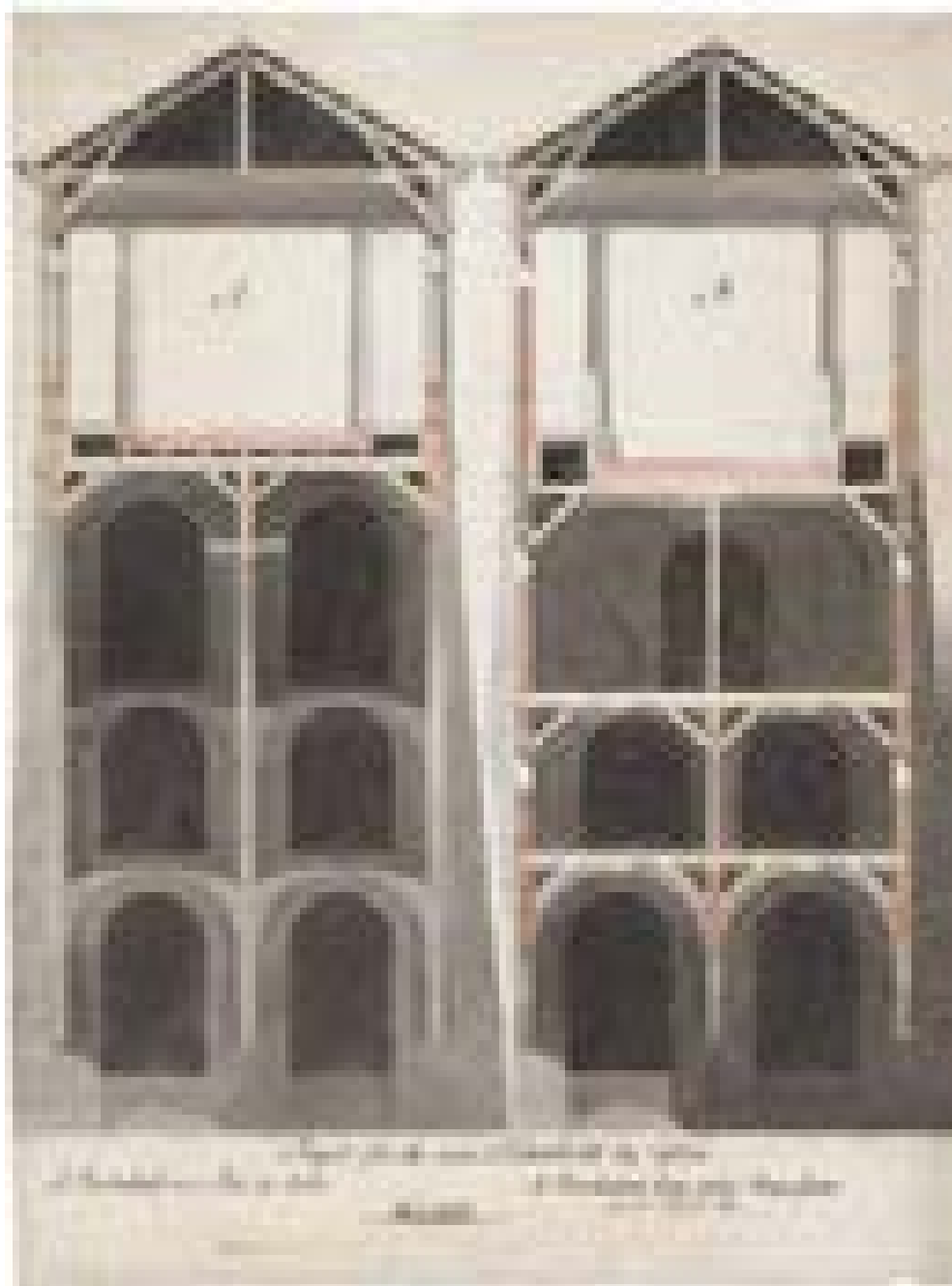
Abb. 4 Brückenquerschnitte mit vorgesehener Dachkonstruktion von David Vogel, III. Blatt, 1807
