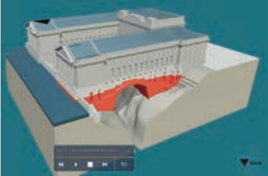
Abb. 2 Pergamonmuseum, Berlin, Stahlbeton-Kolkbrücke über nicht-tragfähigem Baugrund, 1912/1913
