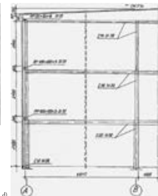
Abb. 8 ›Mehrzweckgebäude Typ Berlin‹: (c) Koppelpunkt der Halbrahmen; (d) Schnitt mit Profilwahl
