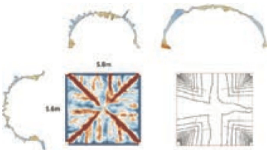
Abb. 5 Tournus, Saint-Philibert, genordete Aufsicht des 2. Jochs der Erdgeschosshalle mit Geometrie der Randbögen (links) und einer Diagonalen (oben rechts), maximale Abweichung 0,11 Meter; und Aufsicht mit Isolinien (unten rechts)
