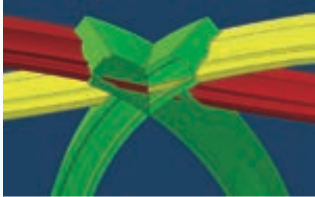
Abb. 2 Prag, Dom St. Veit, Schlingrippengewölbe über der Orgelepore; 3D-Nachkonstruktion eines Rippenknotens – spätgotische Rippenprofile mit mittleren Untersteg (gelb + rot) sowie gebälkförmige Kastenprofilrippen mit zwei lateralen Unterstegen (grün)
